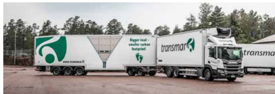
Transmars "dubbeldäckare", ett specialbyggt släp med hydrauliska mellanvåningar för att optimera lastmängderna i två våningar.
