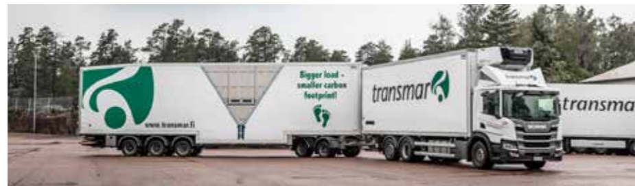
Transmarin kaksikerroksinen "double-decker" on erikoisvalmisteinen perävaunu, jossa on hydraulisesti toimivia välitasoja lastimäärien optimoimiseksi.
