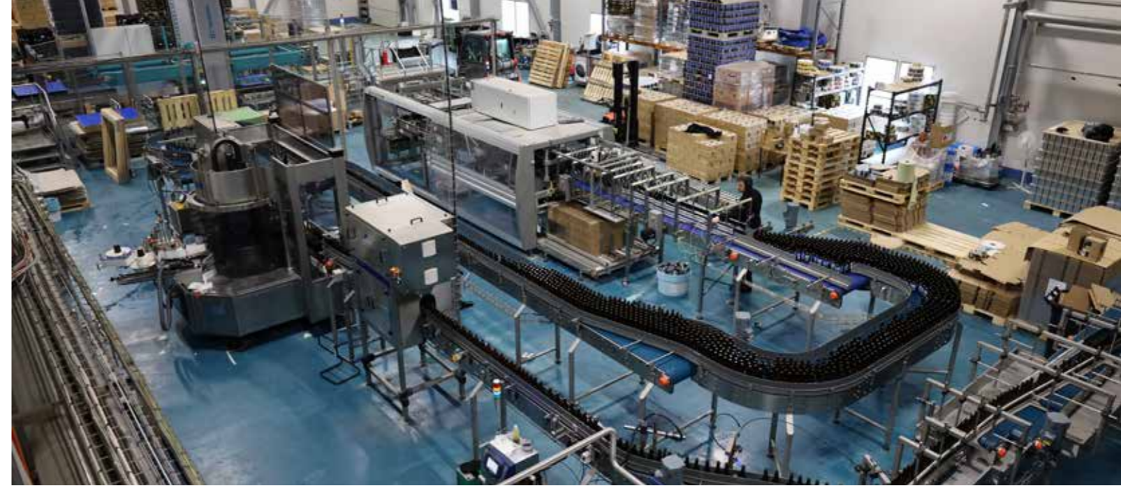
Stallhagenin Godbyn tuotantolaitoksella on muun muassa Euroopan ensimmäinen kone, jolla voidaan käsitellä sekä tölkejä että pulloja.
